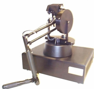
Abbildung 2: Force-feedback Gerät („Phantom 1.5/6DOF“, Hersteller: SensAble Technologies).
